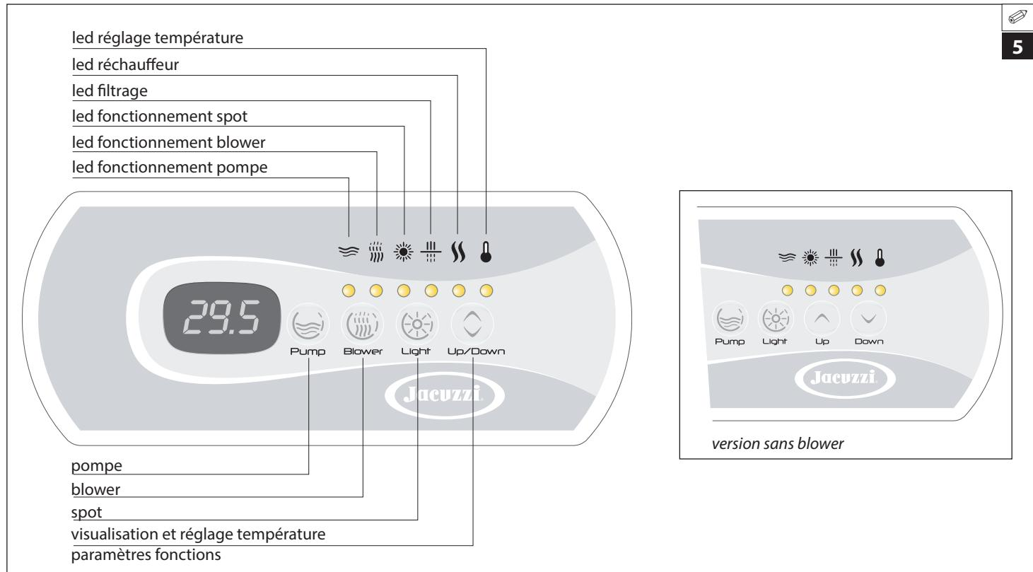
► Appuyer encore une fois sur la touche "Light" ☀ pour sortir de la procédure et sauvegarder les nouvelles valeurs : l'écran s'éteint un instant, puis se rallume. Pour retourner à l'échelle Celsius (°C), rentrer dans la procédure et remettre le chiffre "x" du paramètre **I1x** sur 0.
