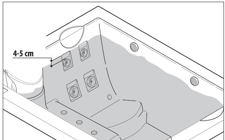
*El llenado se hará con el sistema establecido previamente por el Cliente (vea ficha de preinstalación, cap. "Predisposiciones para la instalación").*
