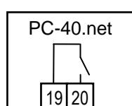
К клеммам 19 и 20 можно подсоединить внешнюю тревожную сигнализацию. Контакт допускается нагружать до 230В 3А
