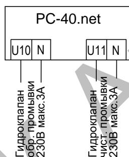
К клемме U10 и N можно подключить штанговый гидроклапан (230В) для проведения обратной промывки.
