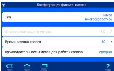
В этом меню необходимо установить тип фильтрующего насоса. При выборе трехфазного насоса необходимо выставить ток срабатывания защиты насоса по шильдику двигателя.
